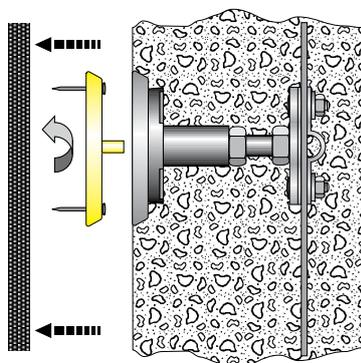
Vyšroubujte žlutý bednicí kotouč z průchodky uzemnění HEA-P a připevněte jej na požadované místo dřevěného bednění hřebíky (4 x průměr hřebíku do 1,6 mm x 30 mm nebo 1 x průměr hřebíků 3,5 mm x 80 mm skrz závitový nátrubek).
